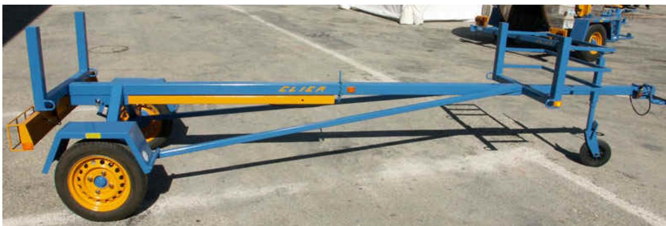
**PORTE POTEAUX RETRACTABLE** (modèle déposé)
